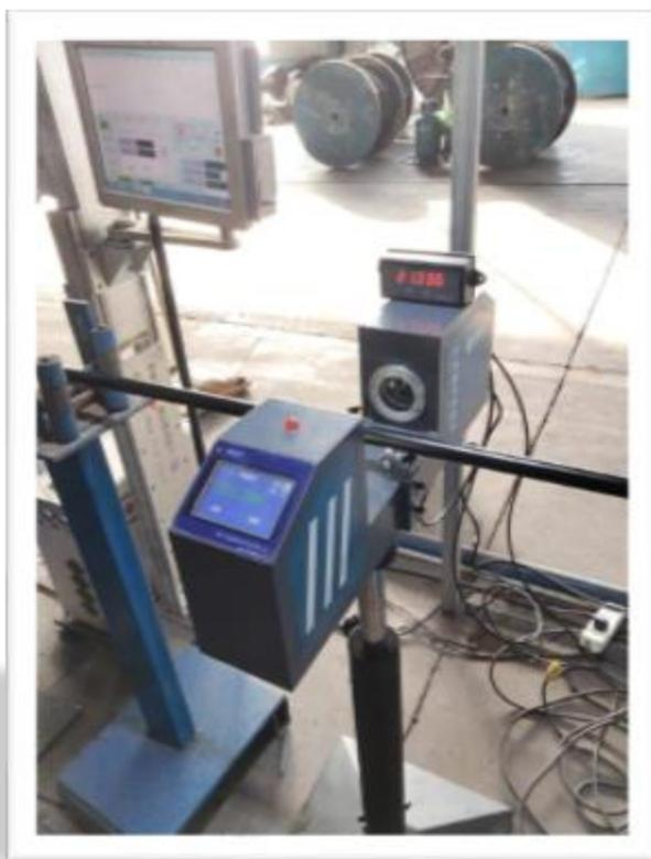
单轴测径仪做到了实时非接触式连续检测，可 24 小时不间断高效率高精度检测，这是人工检测无法达到的。
