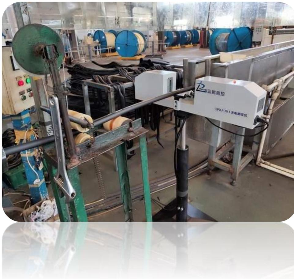
单轴测径仪实现在线检测与闭环控制，在大长度连续叠加组合生产模式下进行测控，让废品率降低，从而使产线在获得同等成品的情况下，原材料的消耗降低，从成本上节约了资金。
